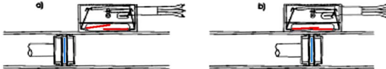
Fine corsa magnetici a) contatto non eccitato b) contatto eccitato.
